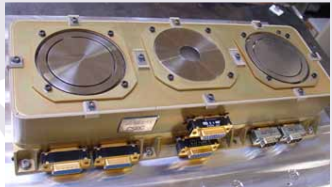
Přístroj TPMU v letovém provedení pro družici Proba-2, rovinná čidla jsou umístěna na horní straně přístroje
