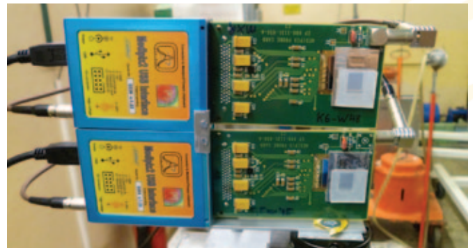
Dva pixelové detektory upravené pro detekci neutronů ve smíšeném radičním poli při měření na cyklotronu v Ústavu jaderné fyziky AV ČR v Řeži u Prahy. Uvedené detektory jsou umístěny na automatickém a dálkově řízeném polohovacím systému pro prostorovou charakterizaci radičního pole.
