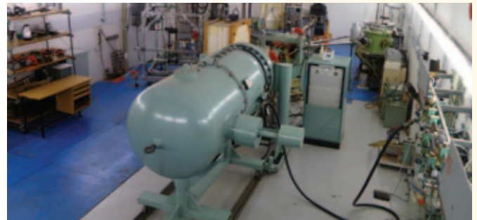
Laboratoř Van de Graaffova urychlovače Ústavu technické a experimentální fyziky ČVUT v Praze. Urychlovač je vidět vpředu, iontovody a experimentální komory jsou v pozadí.
